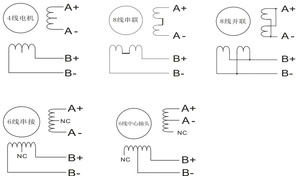
QC57 驱动器可以匹配的步进电机为低电阻低电感的混合式步进电机。
